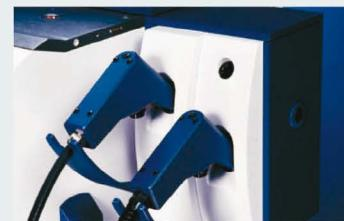
**Sondes fibres optiques** pour mesurer les échantillons directement dans le conteneur.
