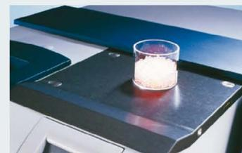
**Sphère d'intégration** pour la mesure en réflexion diffuse sur solides, pâtes, ou échantillons peu homogènes.
