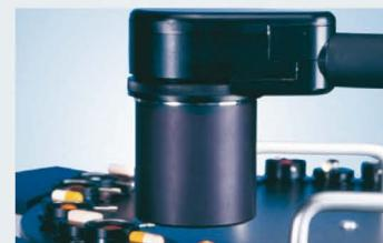
**Unité de transmission** avec en option un passeur d'échantillons permettant les analyses automatisées de comprimés.
